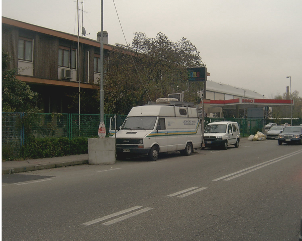
Laboratorio mobile con campionatore gravimetrico per PM10 (1) in Via Milano.
